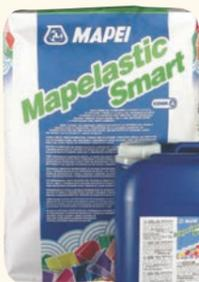
Bi-composant sous protection dure rapportée • Forme après durcissement une membrane adhérente étanche, souple et résistante à la fissuration • Pour planchers intermédiaires intérieurs et murs intérieurs, planchers extérieurs dominant les parties non closes des bâtiments (terrasses, pergolas...) • Primaire obligatoire • Classification : SP3 et SE3.
