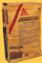
*Utiliser des charges de type siliceuses ou silico-calcaires et non poreuses, propres, de granulométrie 3/8 mm, à raison de 12,5 kg de charges pour 1 sac de 25 kg de Sikagrout-217.*
