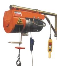
Treuil 230V/50Hz hautes performances • auto-freinant (IP 44) • Lubrification permanente et ventilation extérieure • Télécommande de 1m à 3 boutons • Potence fixe Force de levage : 200 Kg • Hauteur de levage : 25 m.
